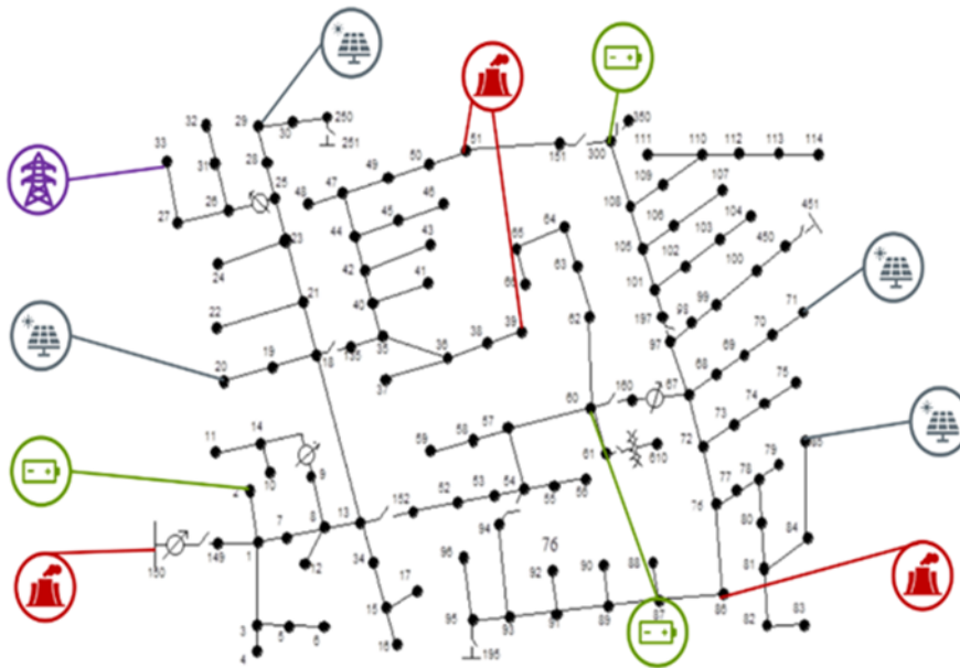
Figura 4.1: Sistema IEEE-123 barras adaptado [33].
