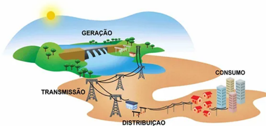
Figura 2.9: Representação ilustrativa de um sistema elétrico de potência [10].
